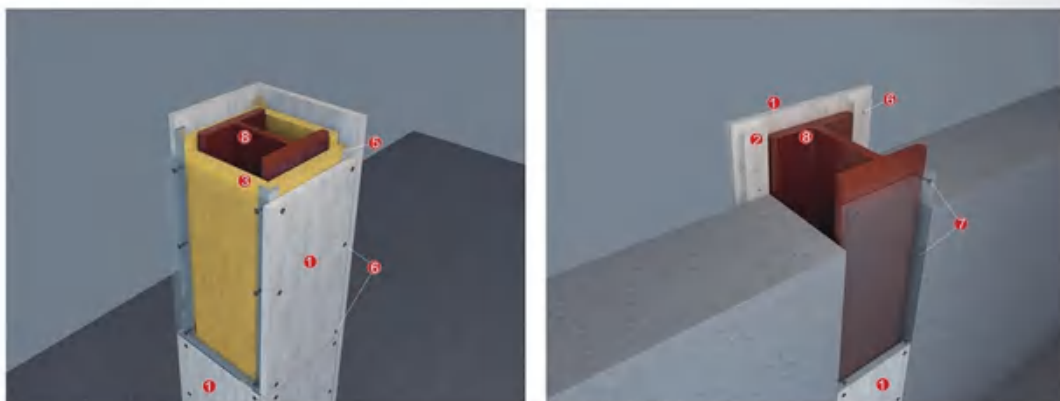
隔热安装包覆
