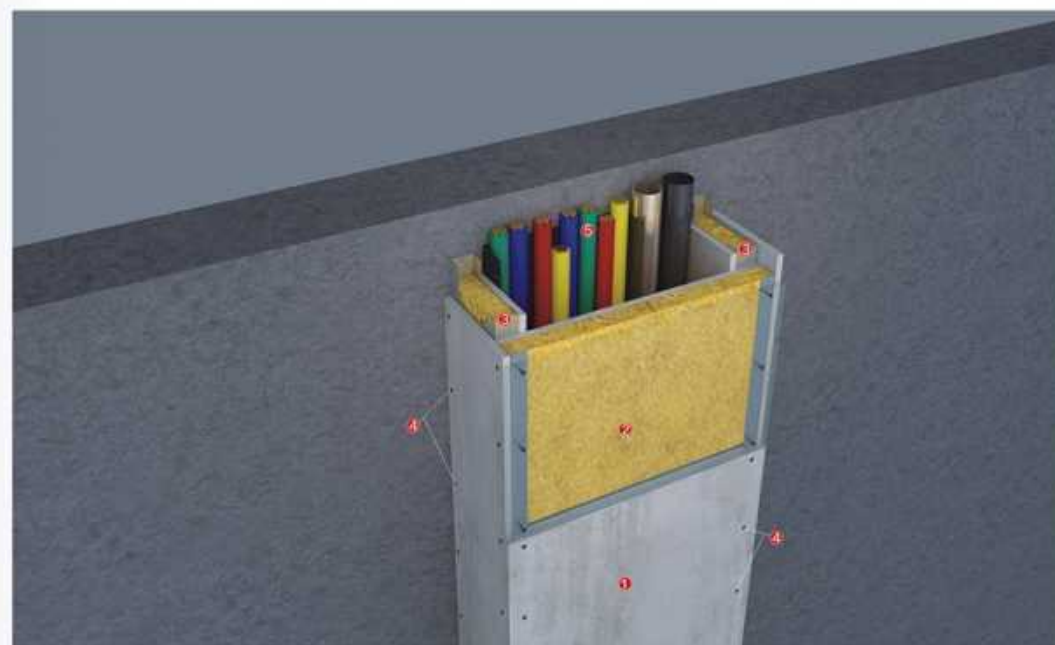
B.管道井电线电缆防火包覆180分钟耐火极限:
